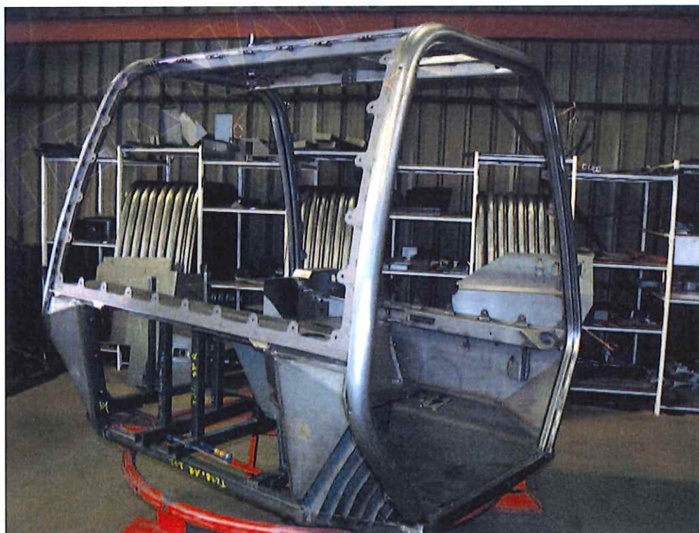
L'ossature de la cabine prend forme avec de multiples soudures manuelles.
