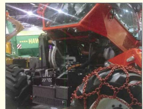
possibilità di personalizzazione senza limiti. Ma attenzione: versatilità, per i tecnici, vuol dire missione molto "dispersiva". Questo comporta un'installazione rigorosa ed attenta. La linea di scarico è ridotta all'osso nel suo sviluppo assiale, trovando un perfetto compromesso tra le necessità termiche della reazione di catalizzazione ed i requisiti fluidodinamici per una buona miscelazione dell'AdBlue.
